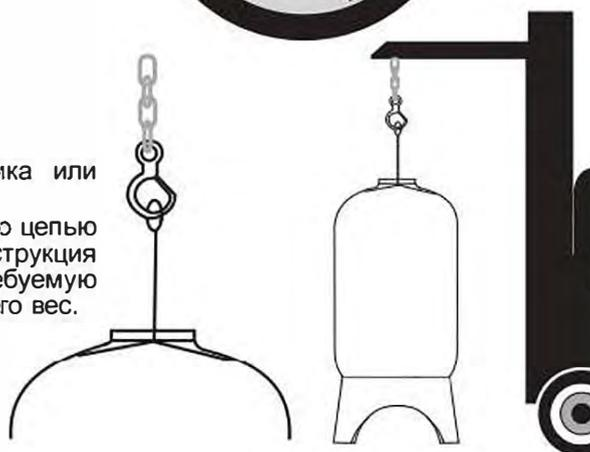
6. При подъеме корпуса используйте такелажную балку с гладкой поверхностью.
