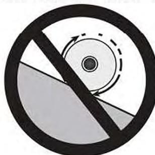
4. Никогда не роняйте стеклопластиковый корпус и не допускайте жестких ударов или трения корпуса о стены, перегородки, инструменты или оборудование.
