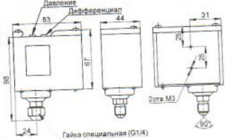
Рис.4 Габаритные и присоединительные размеры РД-2Р-0,8 МПа-G1/2 (модель 35)
